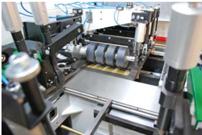
Az alapanyag csúszásmentes előtolását az osztott, pneumatikus hengerek biztosítják
