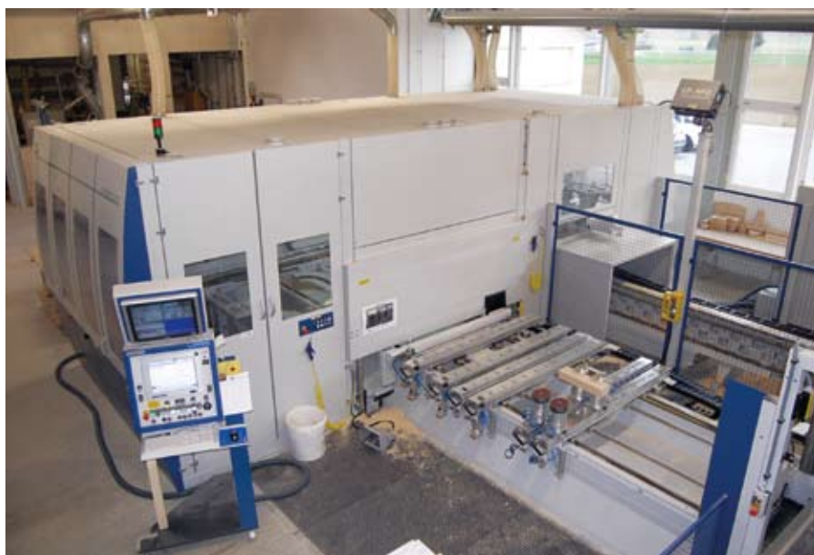
Az „F” jelzésű Conturex CNC-megmunkálóközpontok kétféle gépasztala lehetőséget teremt az alkatrészben való megmunkálásra és a kontúrmarásra egyaránt
